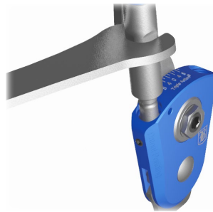
Fig. 2 Régler l'amplitude à 0° en tournant la tige de réglage au maximum dans le sens des aiguilles d'une montre à l'aide de la clé de réglage.
