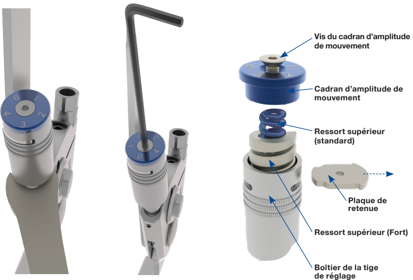
Fig. 4 Régler la tige à 15° d'amplitude.
