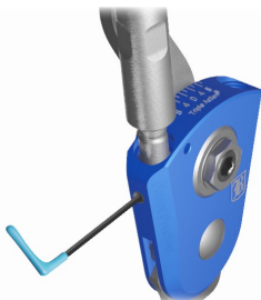
Abbildung 1 Lösen/arretieren Sie die-ROM-Einstellung mit dem 1,5 mm Innensechskantschlüssel, um den Gewindestift für die ROM-Arretierung zu lösen/anzuziehen.
