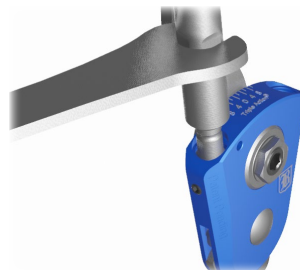
Abbildung 2 Stellen Sie die ROM-Einstellung auf 0° ein, indem Sie die Druckfederverstärkung mit dem Einstellschlüssel eine ganze Umdrehung im Uhrzeigersinn drehen.
