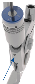
Fig. 3 Desserrer la vis du cadran d'amplitude à l'aide de la clé de réglage de 2 mm et positionner le réglage de l'amplitude du mouvement de flexion plantaire à 0° en tournant le cadran du réglage d'amplitude bleu. Le côté du composant principal où se trouve le canal de flexion plantaire sert de référence pour ce réglage.
