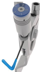
Fig. 1 Débloquer/bloquer l'ajustement d'amplitude de la flexion plantaire à l'aide de la clé de 1,5 mm, et serrer/ desserrer la vis de blocage de l'amplitude.
