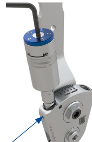
Figuur 3. Draai de ROM-instelling los met behulp van de 2 mm instelsleutel en zet de ROM-instelling van PF op nul door aan de blauwe ROM-instelling te draaien. De plantairflexiekanaalzijde van het componentenlichaam dient als referentie voor deze afstelling.
