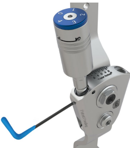
Figuur 1. Ontgrendel/vergrendel de PF ROM aanpassing met behulp van de 1,5mm zeshoeksleutel om de stelschroef voor de vergrendeling van de ROM los/vast te draaien.
