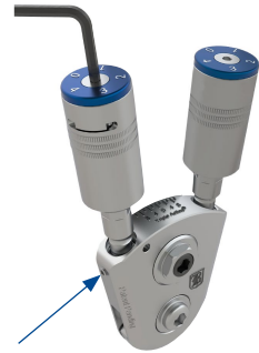
Figuur 3. Draai de ROM-instelling los met behulp van de 2 mm instelsleutel en zet de ROM-instelling op nul door aan de blauwe ROM-instelling te draaien. De ROM lock set-schroef dient als referentie voor deze aanpassing.
