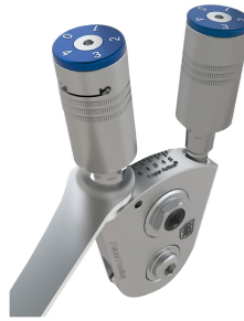
Figuur 2. Stel de ROM-instelling in op 0° door de booster volledig met de wijzers van de klok mee te draaien met de instelsleutel.
