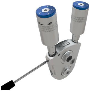
Figuur 1. Ontgrendel/vergrendel de PF ROM aanpassing met behulp van de 1,5mm zeshoeksleutel om de ROM Lock Set-schroef los/vast te draaien.
